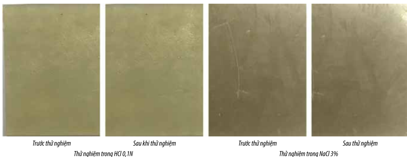
Hình 7. Hình ảnh bề mặt tấm composite polyester gia cường sợi thủy tinh trước và sau 5 tuần thử nghiệm.
