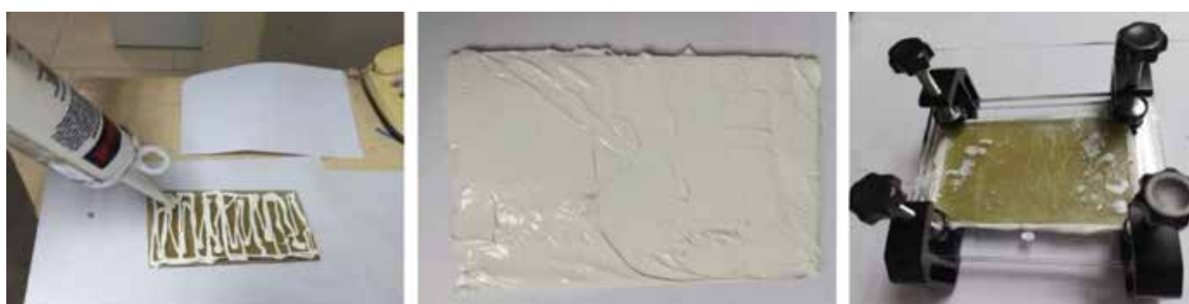
Hình 8. Quá trình tạo hệ composite epoxy/MS polymer/polyester trên bề mặt kim loại.
