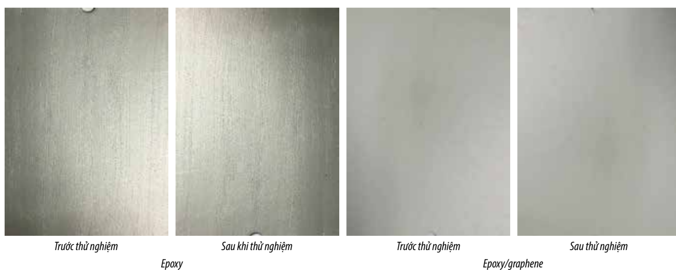
Hình 4. Hình thái học của mẫu sơn epoxy có và không có graphene trước và sau 5 tuần thử nghiệm mù muối.
